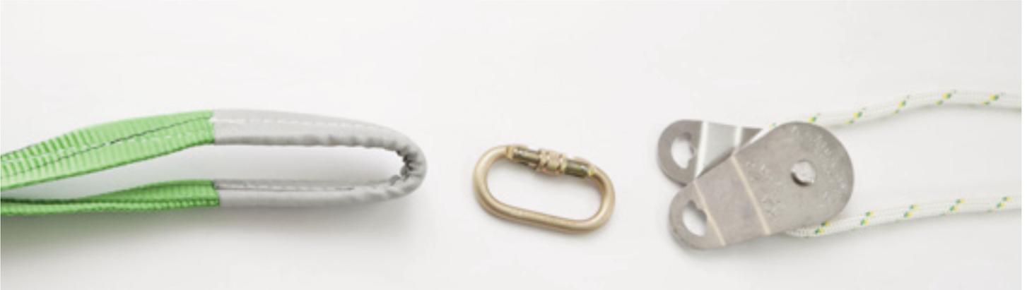
De manière générale, chaque poulie doit être fixée à un point d'ancrage solide à l'aide d'un mousqueton et d'une élingue en respectant le facteur de sécurité approprié. Il faut donc expliquer au client que pour chacune de ses poulies, il lui faudra un mousqueton de capacité appropriée ainsi qu'une élingue. *Voir les pages suivantes sur les facteurs de sécurité.*
