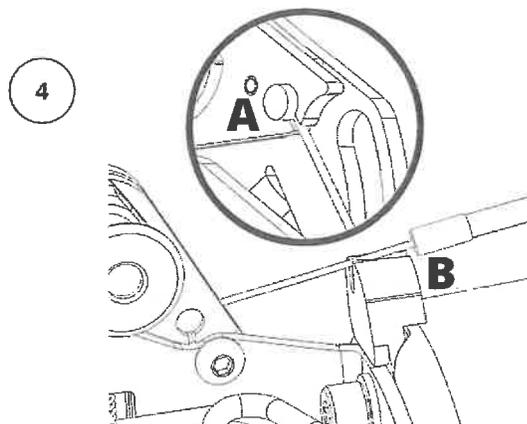
**Insérez le bout du câble dans le trou prévu sur le pivot (A)**
