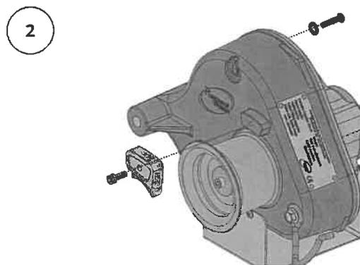
**Retirer le guide corde et remettre la vis**
