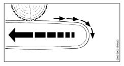
Lorsqu'on travaille avec le côté supérieur du guide-chaîne, la tronçonneuse est repoussée en direction de l'utilisateur.
