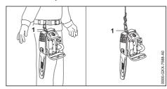
Transporter la tronçonneuse en accrochant l'anneau de suspension (1) à la ceinture ou à une corde.
