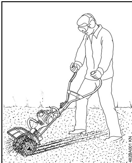
L'outil MultiSystème aérateur RL-MM est conçu pour aérer (scarifier) les surfaces de gazon.
