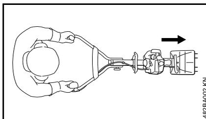
Le moteur MultiSystème muni de l'aérateur RL-MM doit être utilisé en avançant.
