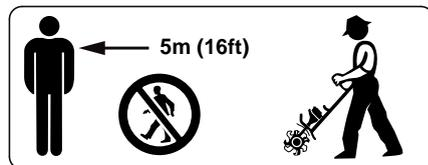
À part l'utilisateur, personne ne doit se trouver dans un rayon de 5 m de la machine en marche – **risque de blessure par des objets projetés, ou en cas de contact avec l'outil de travail !** Respecter également cette distance par ex. par rapport à des véhicules garés, vitres etc. – **pour éviter de causer des dégâts matériels !**
