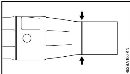
Au cours du travail, la partie avant de la buse s'use en frottant sur le sol. La buse est une pièce d'usure qui doit être remplacée lorsque la marque d'usure limite est atteinte.
